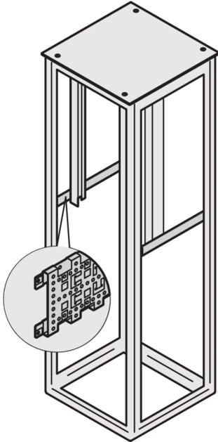
Miembro de profundidad horizontal en la profundidad del gabinete. Montado directamente en el marco Varistar CP para la gestión de cables, mayor rigidez del cuadro y puntos de fijación adicionales.
