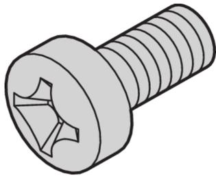
Los tornillos de cabeza de cacerola son un tipo de cabeza común de cabeza de tornillo no avellanada utilizada en tornillos autorroscantes, tornillos autoperforantes y tornillos de máquina. Tienen cabezas anchas, una superficie de soporte plana, lados altos verticales, biselados o curvos, y una superficie superior plana o ligeramente abovedada con un zócalo empotrado.
