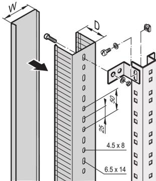
Kit de montaje para canal de cable.
