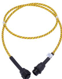
Este paquete de detección de fugas extiende el Varistar LHX+ 45 In-Rack y el RackChiller In-Fila 45 con la capacidad de detectar fugas dentro del dispositivo. El sensor de cuerda se instala en el borde de la bandeja de condensado para minimizar las falsas alarmas a través del agua de condensado o similar.
