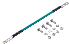
El kit de cables puente de conexión a tierra con aislamiento se sujeta con empalmes para proporcionar una conexión a tierra segura entre secciones de la escalera. Está hecho de cable N.º 6 de protección de cables x 7 hilos con aislamiento verde THW y zapatas de compresión de dos orificios montadas en cada extremo. El kit también incluye sujetadores.
