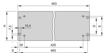
Defina los frentes del dispositivo y los laterales inss con los paneles delanteros Schroff 19". Los paneles delanteros Schroff de 19" tienen agujeros adicionales para el montaje de manijas y están disponibles en dimensiones de 1 U a 6 U.
