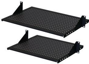
El estante con respiradero ajustable de acero se puede ajustar de frente hacia atrás en incrementos de 25 mm. Está diseñado para soportar equipos de red dentro de un rack de marco abierto. El estante se monta en la brida delantera o trasera de un rack de marco abierto. La clasificación de carga del estante es de 60 lb (27.2 kg)
