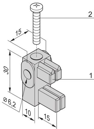
Los soportes de montaje para barras colectoras o módulos Busbar son unidades de montaje aisladas de circuito de carga para rieles de puesta a tierra. Puede haber adaptadores con clasificaciones de corriente asignadas que suministran la corriente de carga a los alimentadores de carga a través de conexiones de cable.
