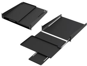
El estante pivotante para teclado se saca y gira 90 grados para acceder a soportes de teclado de tamaño completo en un gabinete o en un rack de marco abierto de 19 pulg. El estante permite que un teclado se deslice entre ángulos de rack estándar e incluye una bandeja para mouse. La bandeja del teclado se extiende 9.75 pulg. (248 mm) más allá de la parte delantera de los ángulos del rack o del rack de marco abierto.
