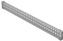
Las rejillas de montaje están provistas de orificios rectangulares especialmente diseñados para permitir el uso de tuercas enjauladas o tuercas enjauladas para carga frontal. Los orificios de montaje se proporcionan en centros de 25 mm. Las rejillas de montaje están disponibles con 1 o 3 filas de orificios y se proporcionan en pares. Se incluye el herraje de montaje para fijar las rejillas de montaje al marco o a otras rejillas de montaje.
