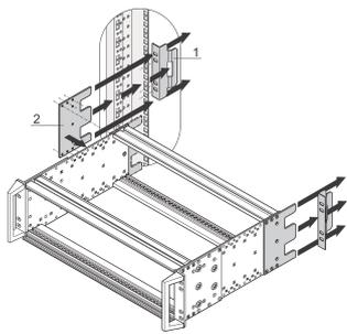
Adaptador para la fijación trasera de un subrack de acuerdo con el estándar DL3 en un gabinete. Garantiza resistencia a golpes y vibraciones de hasta 25 g.
