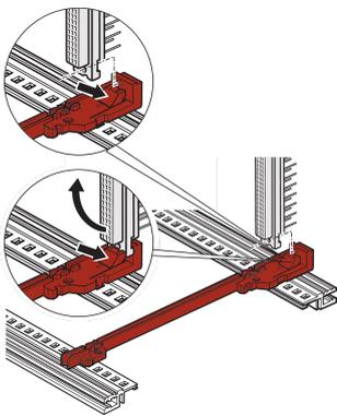
El carril guía estándar con fijación de conector permite al usuario sujetar los conectores DIN (EN 60603-2 (DIN 41612)) directamente a los carriles guía. Solo se aplica con Euroboards con las dimensiones 100 x 160 mm y 100 x 220 mm. Adecuado para RatiopacPRO/-AIR, PropacPRO, CompacPRO y EuropacPRO.
