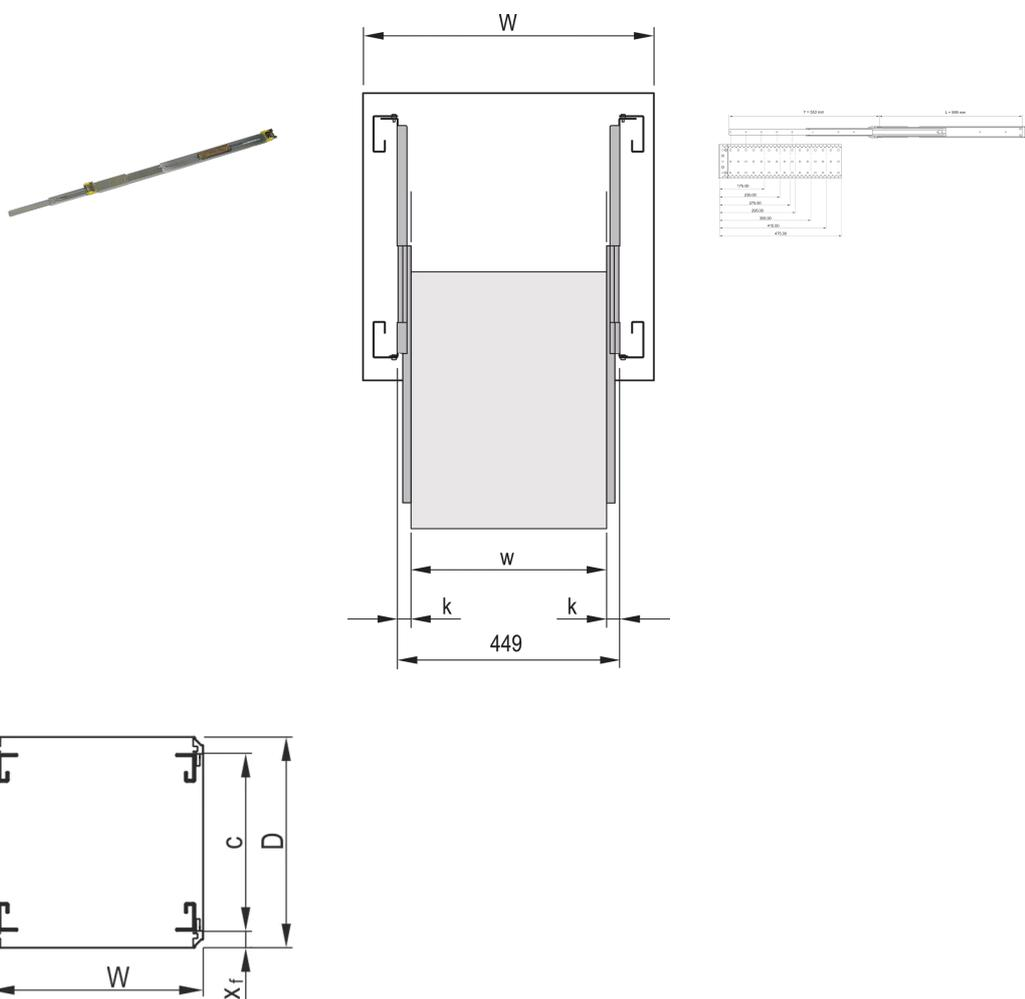
Deslizador telescópico estrecho para subracks con extensión > 100 %.
