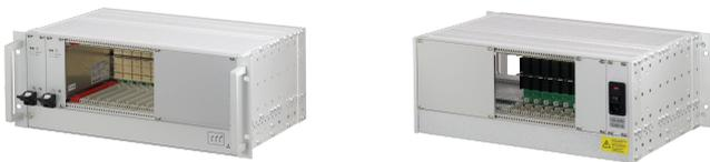
Sistema CompactPCI Serial R3.0 de 4 U, con jaula de tarjeta vertical para nueve placas de 3 U y una fuente de alimentación enchufable de 3U.
