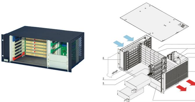
Sistema CompactPCI de 4 U con PSB y H.110, con jaula de tarjeta horizontal para ocho placas de 6 U, eight placas RTM y dos fuentes de alimentación compactPCI de 3 U. Opción de construir hasta cuatro fuentes de alimentación enchufables.
