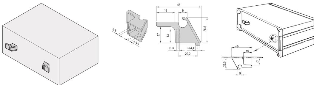
El soporte del cable permite la fijación de cables. El adaptador se puede montar en un panel trasero.
