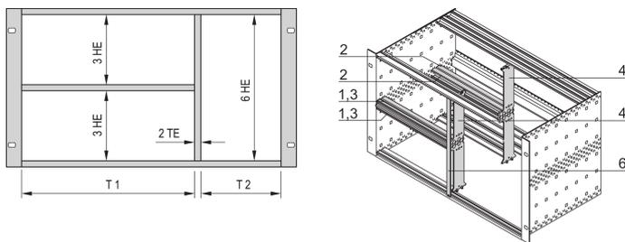
El montaje combinado permite la opción de dividir un subrack o caja de 6 U alto en secciones de 2 x 3 U y 6 U. Diferentes versiones están disponibles.
