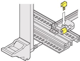
El clip ESD se puede conectar al bloque de clave / codificación del carril guía con codificación. Proporciona un contacto conductor entre el pasador de alineación de la manija del insertor/extractor (IEL o IET) y el riel horizontal.
