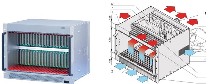
Sistema VME para 21 placas VME de 6 U, 160 mm. La alimentación del sistema se suministra mediante una fuente de alimentación de marco abierto. Un módulo de control de ventilador monitorea los ventiladores, la temperatura y el voltaje.
