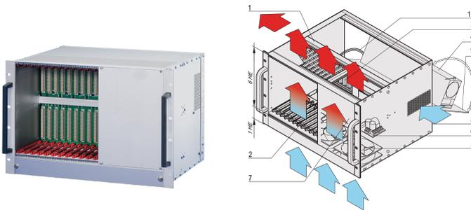
Sistema VME para 12 placas VME de 6 U, 160 mm. La alimentación del sistema se suministra mediante una fuente de alimentación de marco abierto. Un módulo de control de ventilador monitorea los ventiladores, la temperatura y el voltaje.
