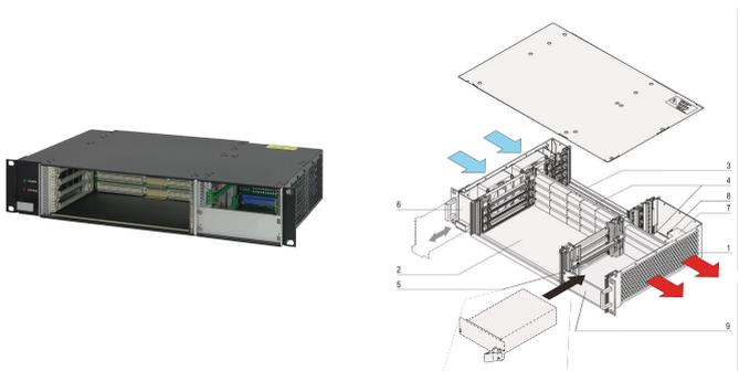
Sistema VME64x para 4 tableros VME64x montados horizontalmente 6 U, 160 mm. Opción E/ S trasera. La alimentación para el sistema es suministrada por hasta dos fuentes de alimentación enchufables. Una bandeja de ventilador de intercambio en caliente con 4 ventiladores garantiza una excelente refrigeración.
