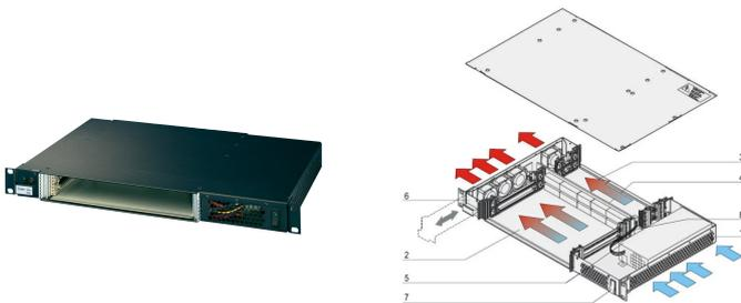
Sistema VME64x para 2 placas VME64x montadas horizontalmente 6 U, 160 mm. Opción E/ S trasera. La potencia para el sistema es suministrada por una fuente de alimentación de marco abierto. Una bandeja de ventilador de intercambio en caliente con 4 ventiladores garantiza un excelente enfriamiento.
