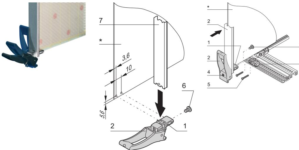
Adecuado para fuerzas de inserción y extracción de hasta 1500 N (por par). Robusto tablero de fijación a través de tornillos dobles. La función de inserción será apoyada por una pieza de teclado que será ensamblada en el riel horizontal.
