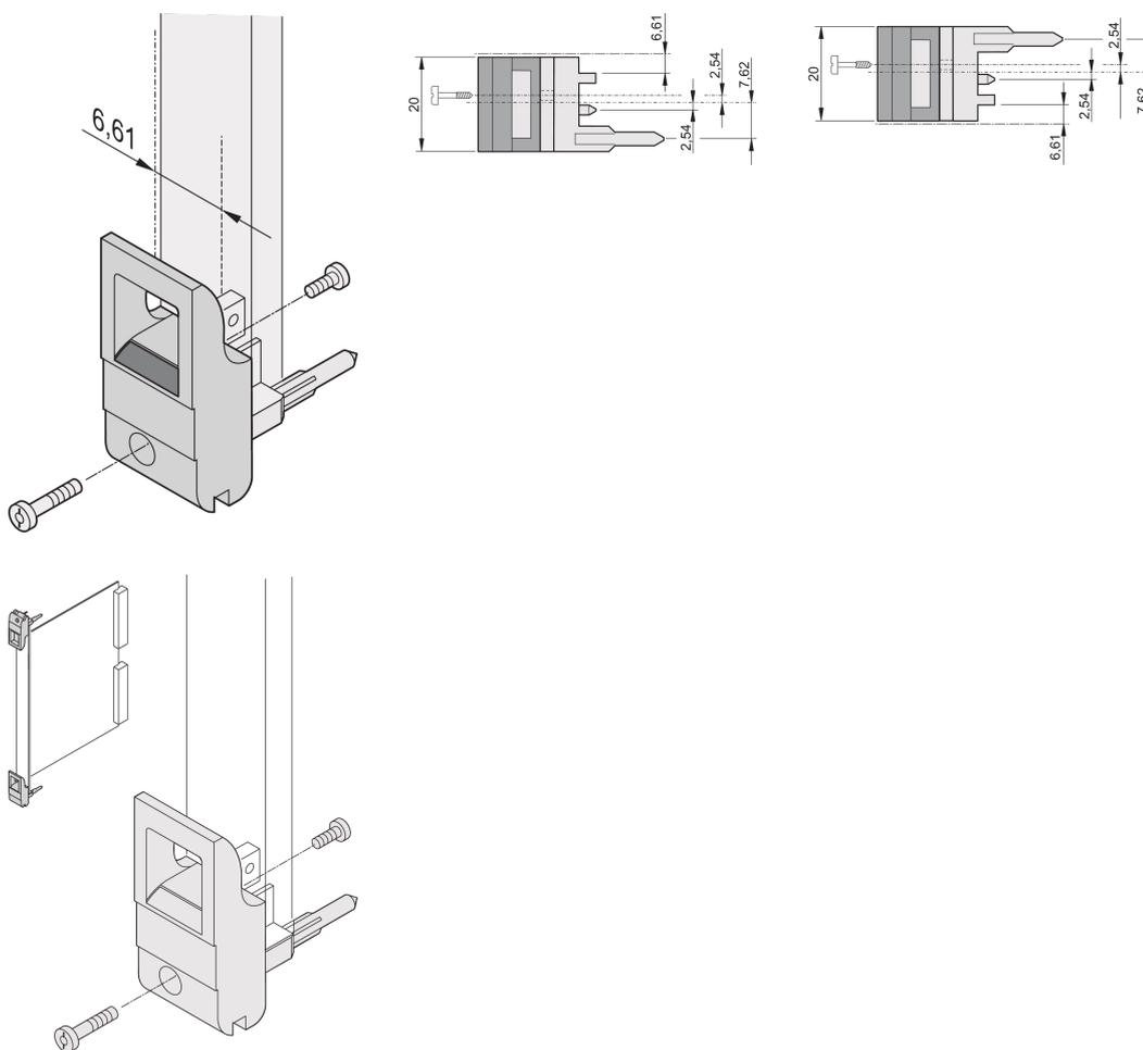
El mango del insertor/extractor, tipo IET de acuerdo con IEEE 1101.10. 0,1" offset. Dos de estos mangos pueden superar una fuerza de palanca única de 700 N (por par).
