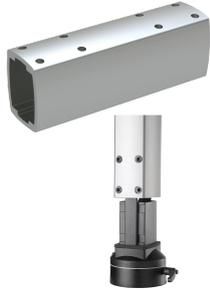
Los tubos Syspend 281-Max brindan integridad estructural y actúan como tubo para el cableado del equipo. Los tubos se conectan a los componentes del sistema con 6 tornillos de fijación en cada extremo del tubo. Los tornillos de fijación permiten un fácil ajuste y nivelación del sistema. Los tornillos de fijación se proporcionan con sellador de roscas que proporciona conexiones seguras.
