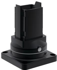
La base giratoria Syspend 281-Max permite que todo el sistema de suspensión gire en el punto de unión en una superficie horizontal. El brazo tiene una capacidad de rotación o giro de 300 grados. Incluye tope de seguridad y rodamiento libre de mantenimiento.
