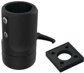
El acoplamiento de brida de tubo redondo Syspend 281-Max de 48 mm fija el tubo pedestal de movimiento vertical o cualquier tubo redondo de 48 mm al gabinete. El gabinete se puede girar 300° y fijarse en la posición deseada. Incluye tope de seguridad y rodamiento libre de mantenimiento.
