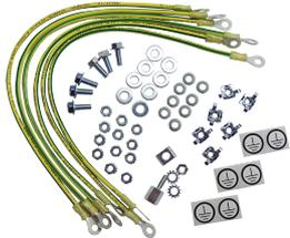
El kit de conexión a tierra permite conectar a tierra un gabinete ProLine o ProLine G2 según las especificaciones VDE. Incluye seis cables de calibre 12 de 411 mm (16.19) de largo con terminaciones de anillo y hardware de montaje M6.
