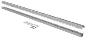
Los ángulos del rack ProLine G2 se montan con sujetadores BV-M6 en lugar de la combinación tradicional de tuerca encajada y tornillo. La altura del ángulo del rack y el recuento de unidades del rack están optimizados para las alturas del marco ProLine G2. Los ángulos del rack tienen dos superficies de montaje que sirven para la conexión de equipos y accesorios de montaje en rack. Los ángulos del rack cumplen con las normas de montaje en rack AN SI/EIARS-310-D.
