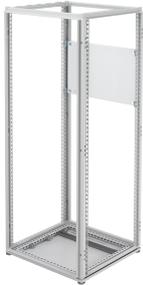
Los subpaneles parciales tienen bridas en cuatro lados. Los paneles se pueden colocar verticalmente en incrementos de 25 mm y también se pueden colocar a cualquier profundidad en incrementos de 25 mm utilizando las rejillas de montaje opcionales. Se incluyen todos los herrajes de montaje necesarios.
