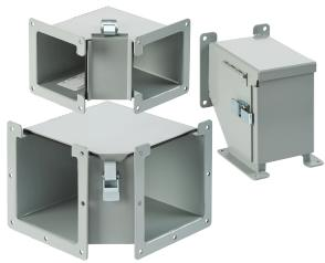
El codo de 90° con cubierta con bisagra empotrada y abertura superior exterior se usa para instalaciones de ductos para cableado en ángulo recto. Debido a que las secciones de ducto colocado pueden montarse con cubiertas orientadas en cualquier dirección, se encuentran disponibles tres codos de 90° diferentes. La selección adecuada permite al usuario mantener el mismo acceso y, por lo tanto, preservar la función de colocación para instalaciones con ángulos rectos.
