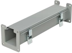
Los accesorios de recorte con cubierta abisagrada se usan para longitudes de 9.00 pulgadas (229 mm) a 15.00 pulgadas (381 mm). La estructura viene en dos piezas. Acorte la estructura y la cubierta hasta la longitud deseada y suéldelas. Las conexiones tienen un acabado de pintura sobre superficies revestidas.
