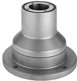
CS480 El acoplamiento de soporte de base giratoria externa monta el gabinete directamente en superficies horizontales, lo que permite una rotación del gabinete de 340°. Los herrajes de montaje de la base están expuestos. Rodamientos libres de mantenimiento.
