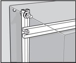
Los canales de montaje proporcionan un marco de montaje para instalar rieles DIN y rejillas de montaje en varias posiciones dentro del gabinete. Los canales se pueden montar vertical u horizontalmente en los pernos del collarín o en los mecanismos deslizantes del kit de montaje de profundidad ajustable.
