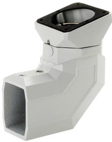
Acoplamiento de codo de brida Compact Series 2, 15 grados se conecta directamente al gabinete para aplicaciones donde no se requiere un tubo vertical, lo que permite una rotación del gabinete de 300 grados y una inclinación de ángulo de 15 grados. El rodamiento libre de mantenimiento es de acero y poliamida. Incluye una placa de acceso para una fácil instalación de cables.
