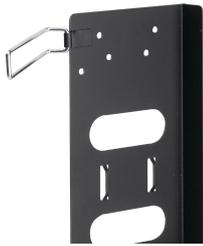
El administrador vertical de cables I se utiliza para enrutar y agrupar cables dentro de los gabinetes. Para lograr una trayectoria vertical completa en gabinetes de 1800 mm o más, se deben apilar dos unidades. Las bisagras de la puerta Wireform se abren para facilitar el enrutamiento de los cables. Se monta en un riel sujetador o en un marco frente a los ángulos para rack. El perfil estrecho no interfiere con el equipo de 19 pulg. en gabinetes de 600 mm de ancho.
