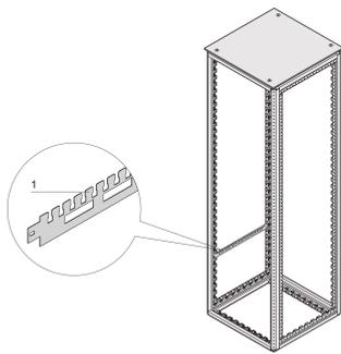
Carril de soporte de cable horizontal Varistar en la profundidad del gabinete. Montado directamente en el marco.
