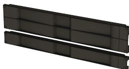
Los paneles ciegos sin herramientas (a presión) proporcionan una instalación sin herramientas y garantizan un flujo de aire adecuado al equipo. Están hechos de plástico térmico aprobado por UL y se pueden usar con ángulos de montaje en rack espaciados universales EIA con rosca o cuadrados.
