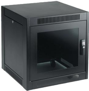
Los gabinetes SOHO están diseñados para albergar servidores, equipos de redes y equipos telefónicos y de correo de voz debajo de un escritorio. Las ruedas permiten que el gabinete se mueva fácilmente para acceder a él. El equipo se enfría pasivamente mediante el aire que se toma desde la parte delantera del gabinete y se expulsa a través de los recortes del ventilador en la parte posterior, que pueden aceptar ventiladores opcionales para aplicaciones más cálidas.
