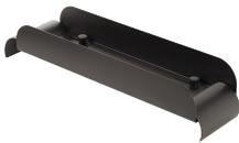
La parte superior de cascada con marco abierto se usa para tender el cable a través de la parte superior de un rack de marco abierto. Proporciona un radio de doblez de transición horizontal a vertical para la instalación de cables de fibra óptica y de categoría 5, 6, 6A. También es un sistema completo de gestión de cableado cuando se usan organizadores de cables verticales y horizontales. La parte superior de cascada se monta en racks de marco abierto de 2 y 4 postes.
