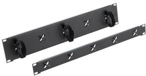
Los paneles de amarre de marco abierto proporcionan un punto de montaje para tender el cable en un rack de marco abierto. Se montan horizontalmente en racks de 19 pulg. y los paneles tienen ranuras para envoltura de VELCRO® para cables. Cada panel incluye 10 envolturas de VELCRO para cables color negro de 8 pulg. (203 mm) con los herrajes de montaje. Tenga en cuenta que VELCRO es una marca comercial de Velcro Industries BV
