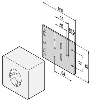
Placa de montaje para solo Socket.
