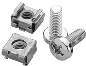
El kit de paquete de tuercas enjauladas y sujetadores M6 incluye un juego de 8 tuercas y tornillos enjaulados. Se utiliza para montar equipo de rack de 19 pulg. en aberturas cuadradas de 9 mm en vertical. Las tuercas enjauladas son métricas (M6) mientras que los tornillos son de cabeza plana Phillips métrica M6x16.
