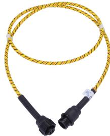
Este paquete de detección de fugas extiende el Varistar LHX+ 45 In-Rack y el RackChiller In-Fila 45 con la capacidad de detectar fugas dentro del dispositivo. El sensor de cuerda se instala en el borde de la bandeja de condensado para minimizar las falsas alarmas a través del agua de condensado o similar.
