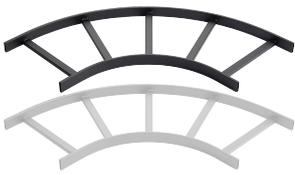
La sección horizontal a 90 grados proporciona un cambio horizontal de 90 grados en la dirección de la guía de cables. Está hecho de acero tubular de 1-1/2 pulg. x 3/8 pulg. (38 mm x 8 mm). La curvatura E se conecta a secciones rectas con kits de conexión de empalmes. Está diseñado para cables de fibra óptica de categoría 5e, 6, 6A.
