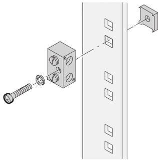
Estas abrazaderas de puesta a tierra mecánicas están diseñadas para su uso con cable a barra en sistemas de puesta a tierra y unión. La abrazadera de puesta a tierra Schroff permite una sección transversal de 100 mm<sup>2</sup>.
