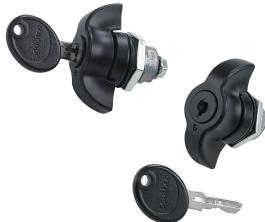
La perilla mariposa de cuarto de vuelta del sistema de cierre bloquea una variedad de gabinetes de montaje en pared. La perilla mariposa incluye una junta, tuerca de montaje y una llave con el código de llave 333. Esta perilla mariposa debe usarse con una leva existente para su instalación; tenga en cuenta que la leva no está incluida con la perilla mariposa. Se puede bloquear en posición abierta o cerrada. Este producto mantiene la clasificación del gabinete Tipo 4, 12.
