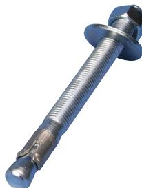
El kit de perno de anclaje de expansión para concreto es para uso con racks de marco abierto sísmicos y no sísmicos. Se utiliza para anclar racks de marco abierto al piso, proporcionando soporte durante eventos sísmicos. Incluye (4) pernos, arandelas y tuercas de 3/8 x 3.75 pulg.
