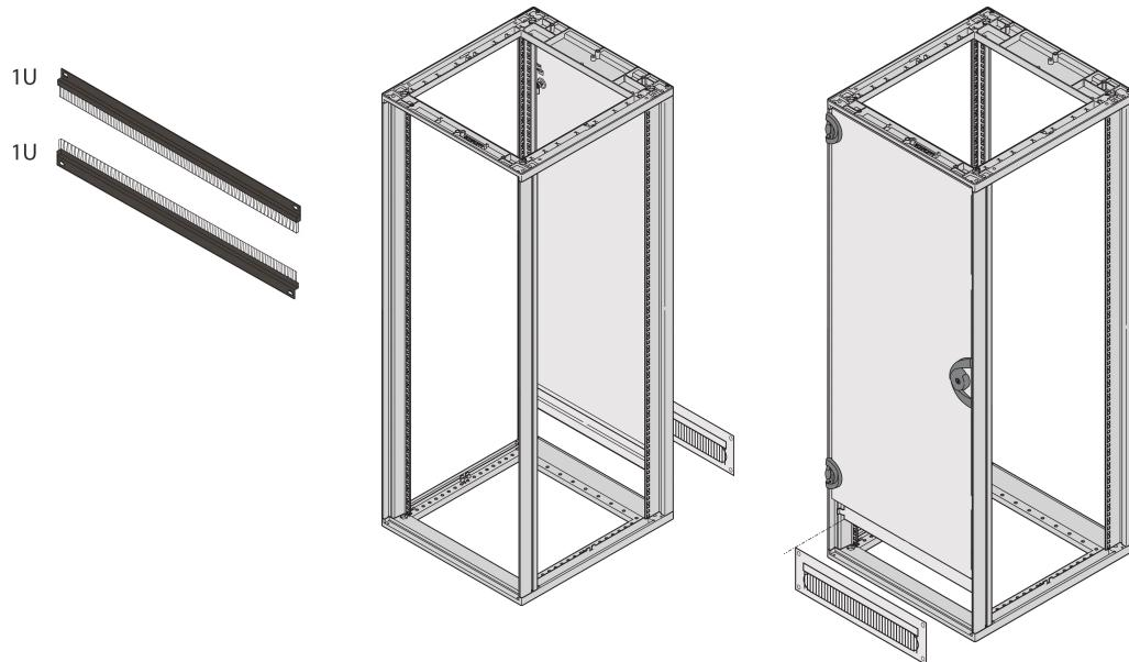
Tira de cepillo a través de la cual se ejecutan conductos de conductores eléctricos aislados, generalmente conductores que transportan grandes corrientes.
