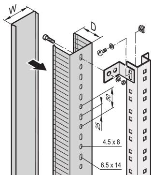
Conductos de cables en áreas laterales y traseras del gabinete y montaje en verticales del gabinete, miembros de profundidad o perfiles en C.
